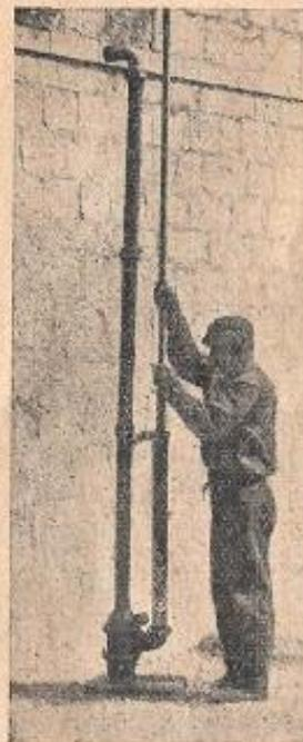
Fig. 3. — Pompa Filadelfia: la base va immersa nel pozzetto. Alla cima si innesta una manica di tela impermeabile che permetta di condurre il colaticcio nel mezzo della superficie della massa.
